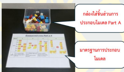
ภาพที่ 4-1 กล่องสำหรับใส่ชิ้นส่วนสำหรับใช้ในการประกอบโมเดล Part A และมาตรฐานการประกอบขั้นตอนการประกอบโมเดล Part-a1, Part-a2, Part-a3, Part-a4 และ Part-a5
